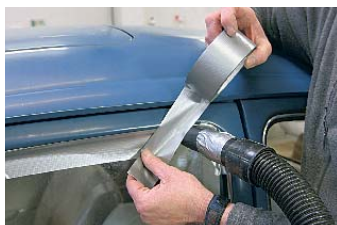
Schotten dicht: Ist alles gereinigt, kommt das Ozon zum Einsatz.
