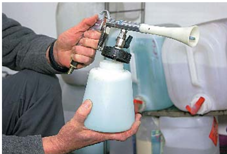
Der „Tornador“ ist eine Saugbecherpistole, die mittels spezieller Düsenkonstruktion den Reiniger haarfein und mit hohem Druck zerstäubt. Jede versteckte Ecke ist erreichbar
