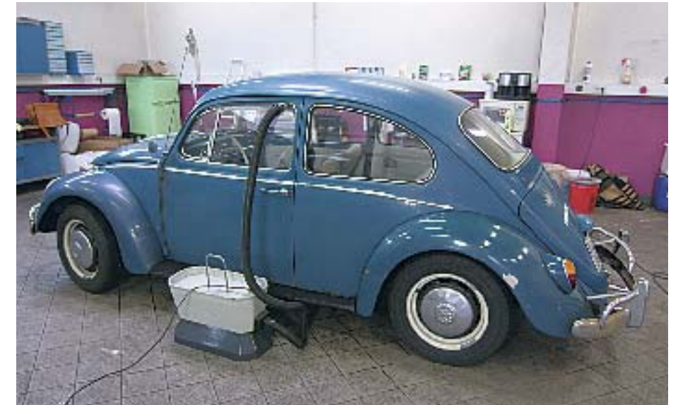
Kräftige Brise: Bis zu 24 Stunden kann man die Ozon-Behandlung durchführen. Das Gas reagiert mit den übel riechenden organischen Verbindungen, Schimmel wird abgetötet
