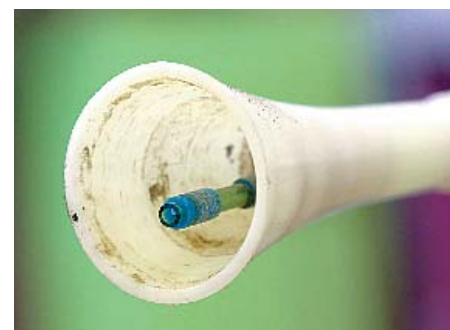
Der blaue Schlauch mit der Düse rotiert im Betrieb und erzeugt den Tornadowirbel
